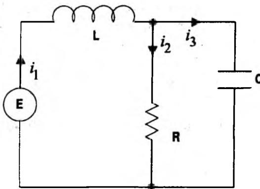
**Ejemplo.-** Resolver el sistema (\*) con las condiciones  $E = 60V$ ,  $L = 1H$ ,  $R = 50\Omega$ ,  $C = 10^{-4} F$ , y donde  $i_1$  e  $i_2$  son inicialmente igual a cero.
