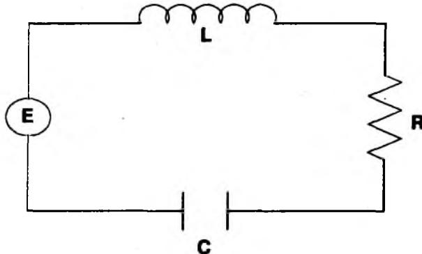
**Ejemplo.-** Determinar la corriente  $i(t)$  en un circuito simple L-R-C si  $L = 0.1 \text{ H}$ ,  $R = 20 \Omega$ ,  $C = 10^{-3} \text{ F}$ ,  $i(0) = 0$  y si la tensión aplicada  $E(t)$  es como se muestra en la figura
